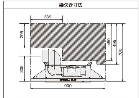
※上記図は、不燃材20mm、側方排気時を示します。
