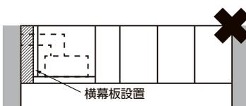
※横幕板の設置が必要なため、図のような横方向へのダクト配管は対応不可。
