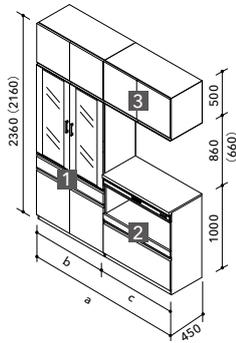
1 カップボード(1段引出し・サイレントレール) 2 家電収納庫(サイレントレール) 3 カップボード上台
