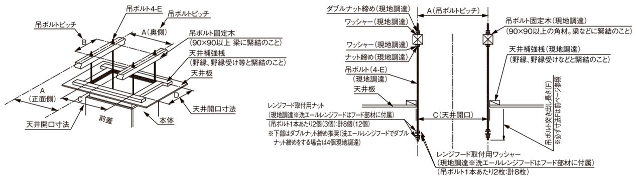
吊りボルトは垂直に設置してください。吊りボルトが斜めに設置されていると、部品のゆがみや部品間に隙間が生じる可能性があります。
