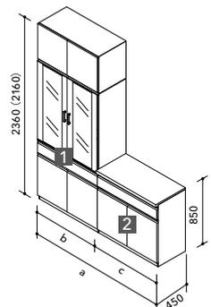
1 カップボード(1段引出し・サイレントレール) 2 フロアカウンター(1段引出し・サイレントレール)
