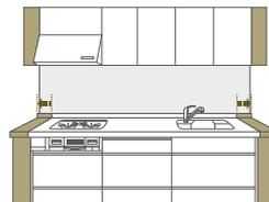
フィット&フィットシステムとファイラー(調整板)を利用し、隙間のない美しいキッチンを実現できます。
