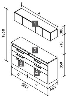
1 吊戸棚 開き扉タイプ 2 カグタス収納用フロアカウンター 3 4 下台 オープン棚付3段引出しタイプ
