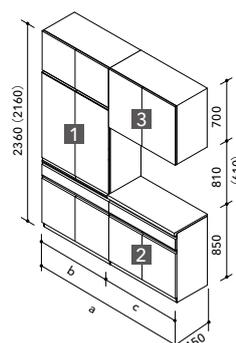
1 カップボード(1段引出し・サイレントレール) 2 フロアカウンター(1段引出し・サイレントレール) 3 片面フロアキャビネット上台(D450)
