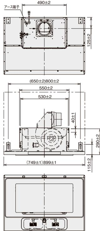
※後方排気の場合、上図のように排気シャッターが壁面に入り込みます。上図寸法を考慮の上、躯体・設備工事をおこなってください。
