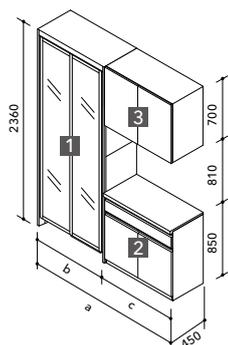
1 システムスライド 2 フロアカウンター (1段引出し・サイレントレール) 3 片面フロアキャビネット上台 (D450)
