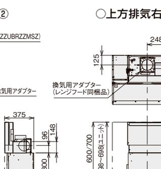
※本図の寸法は鋼板幕板仕様、( )寸法は化粧幕板仕様を示す。 ※配管レイアウト上、アタッチメントが2個必要になる場合は、排気用以外に給気用として別途1個ご用意ください。
