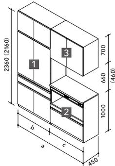
1 カップボード(1段引出し・サイレントレール) 2 家電収納庫(サイレントレール) 3 片面フロアキャビネット上台(D450)
