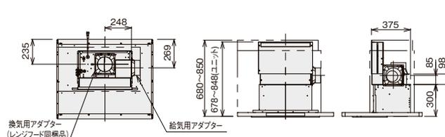
※左側排気上方給気②は、現場にて排気電動シャッターの取付位置を変えることで①に対して排気位置を下げる事が可能です。
