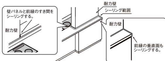
●耐力壁対応キャビネットは、見切り付キャビネットと組み合わせレイアウトしてください。見切り付キャビネットと同梱の見切り材(t=15)を耐力壁対応キャビネットと側壁の間に取り付けます。
