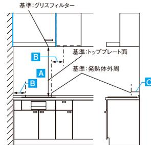
＜上方離隔距離＞ 加熱機器の上方離隔はレンジフード・不燃材の場合でも表中の距離を守ってください。
