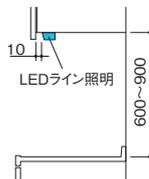
・LEDライン照明は、ウォールユニットの前面より10mm後方にひかえた位置に設置してください。
