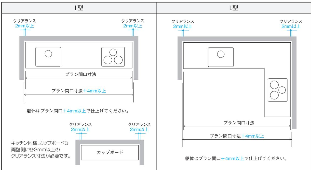
クリアランス寸法分は、仕上げ時シーリング材の充てん処理
