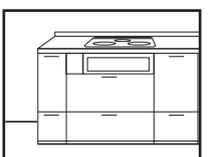
「壁納めなし」のコンロ用スライド収納の横には、ユニットが隣接設置できます。また、コンロ側がオープンの場合にエンドパネルを設置しても、きれいに納まります。
