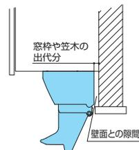
コンビネーションパレットの下に窓枠や垂壁の笠木など、壁面から突起物がある場合は、出代分前方に設置してください。
