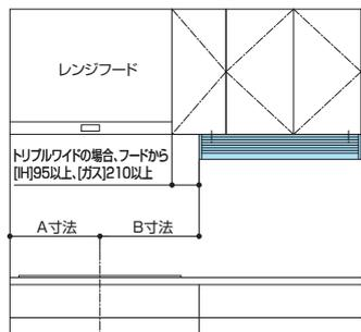
① 加熱機器センターから下記の離隔距離を確保してください。
