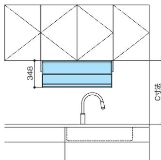
コンビネーションパレットを水栓金具周辺に設置する場合、水栓金具との干渉を防ぐため、カウンター面からウォール下端までの寸法(C寸法)は下記以上必要です。
